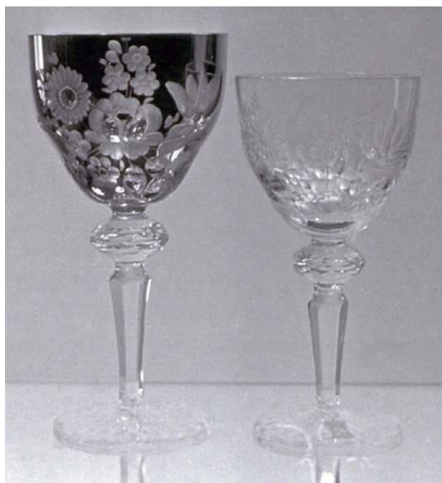
Bild 7: Gleiche Schliff-Dekore, rechts – auf unbeschichtetem, links – auf beschichtetem Kelch
