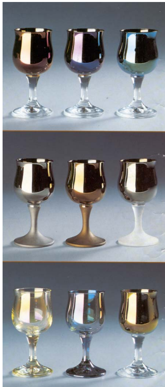
Bild 3: Erste Muster (Likörgläser „Saphir“) mit Ti (silberfarbig), TiN (goldfarbig) und Ti-Oxid (regenbogenfarbig) beschichtet
