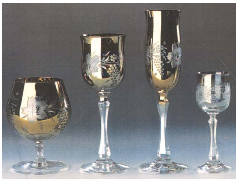
Bild 8: Manueller Weinlaub-Schliff auf beschichteten Kelchgläsern
