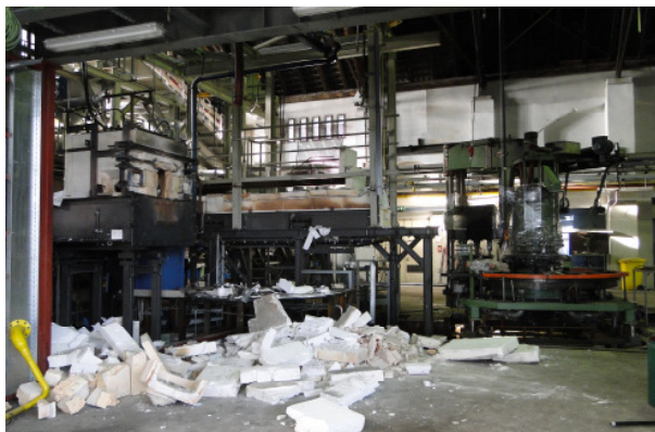
Abb. 20 bis 22: Demontage der 10-Station-Waltec-Press
