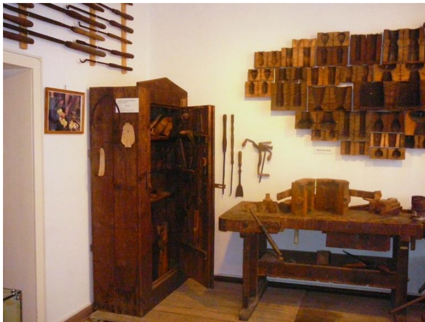
Holzformen und Werkzeuge zur Herstellung derselben im Glasmuseum Weißwasser
